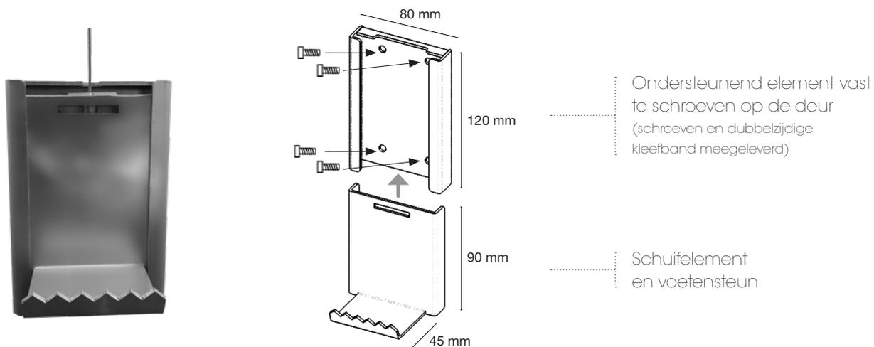
De bevestiging van de steun aan de onderkant van de deur moet voorzichtig gebeuren door de deurendel in de gesloten positie te houden. (horizontaal = geen druk op de kabel)
